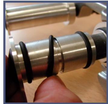
Las anillas garantizan una conducción antideslizante y una exacta guía de las bandas de lija.
