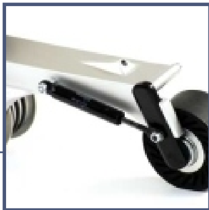
Nuevo sistema de amortiguación con presión de gas.
