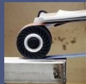
El rodillo suave permite que las superficies lisas sean lijadas horizontalmente, por ejemplo, para eliminar puntos de soldadura o arañazos profundos, etc.
