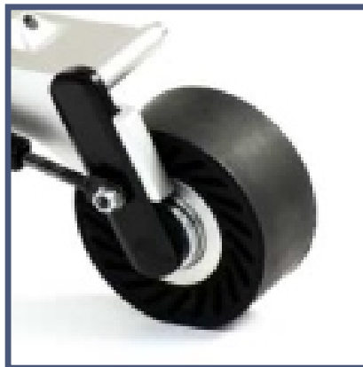
El rodillo conductor con anillas de goma asegura que las bandas de lija no se deslicen. Las anillas gastadas pueden ser sustituidas rápidamente y a un muy bajo coste.
