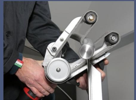
**La lijadora de tuberías suiza de gran alcance para el trabajo con el metal. Poli-Romy / 1, con su brazo móvil, se adapta alrededor de todos los lugares.**
